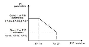
Fig6-27 PID parameter switching
