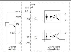
Fig. 3-24 Leakage-type wiring mode
